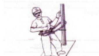
**Paso 2 :** Rodear la estructura, dar dos vueltas y conectar el otro extremo al otro punto de anclaje lateral del cinturón. Ajustar la longitud de la cuerda utilizando el elemento regulador.
