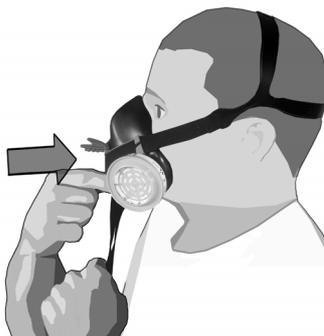
(2) Posizionare la bardatura sulla testa e la maschera sul viso.
